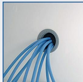
Passage de cuve Ø 30mm pour caractérisation/qualification sur site, positionné sur la porte à 1/3 du haut (pour chaque compartiment).
